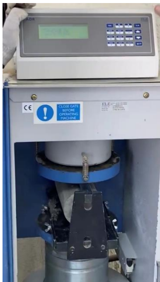
Fig. 7 Split tensile apparatus
